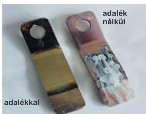
TOPAS 3100 + PROSEALXZ 111 (+ PROSEAL Nanoadditív) + SURFASEAL WL150 840 h után DIN EN ISO 9227-ben
