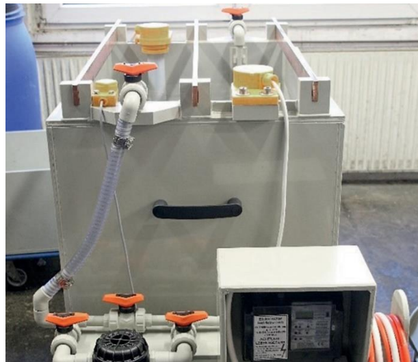
3. ábra: Dobos tesztekhez való berendezés. A kád szivattyúval, fűtéssel és ioncserélő oszloppal van felszerelve.
