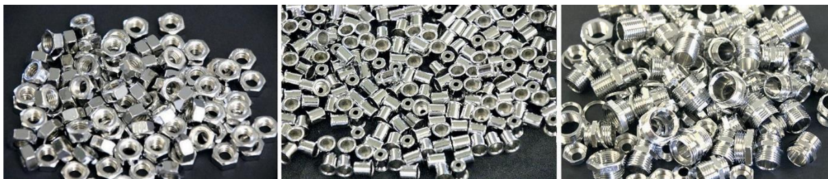
1. ábra: A műszaki központban SAPHIR 2050-nel bevont minták
